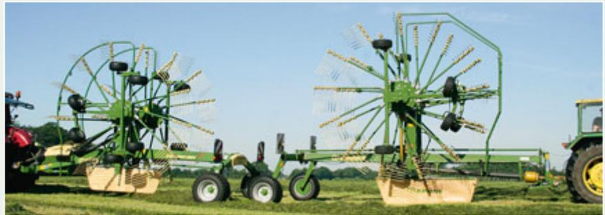
Deutlich niedriger baut der neue TC 880 bei einer Bodenfreiheit in Transportposition von 28 cm.
