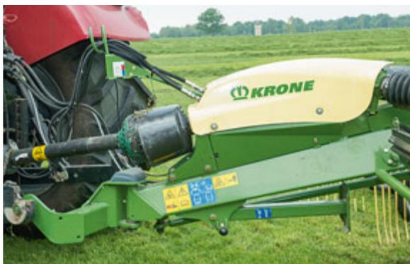
Ebenfalls neu entwickelt ist in diesem Zusammenhang die mechanische Transportsicherung. Diese Idee ist so simpel und genial zugleich: Damit die Kreisel ausgeklappt werden können, müssen sie zunächst mit dem doppelwirkenden Steuergerät auf mindestens 7,80 m Arbeitsbreite austeleskopiert werden. Das Rechteckrohr samt Kreisel wird nach oben geschoben und gibt je eine Klaue frei, die nach innen schwenkt, sobald die Kreisel mit dem einfachwirkenden Steuergerät ausgeklappt werden.
