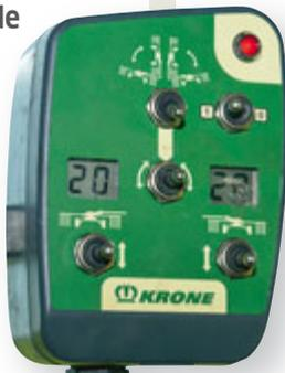
Die „Plus“-Variante ermöglicht den Einzelkreiselaushebung. Die beiden Skalen geben in etwa die Rechthöhe in Millimeter an.
